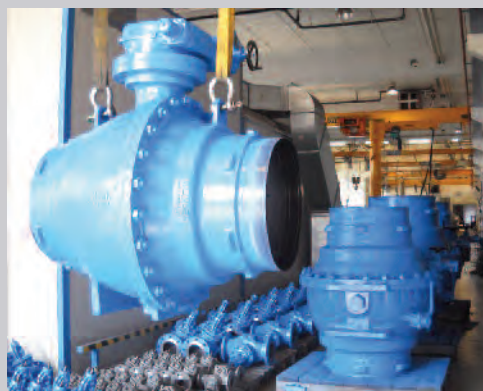
Réseau de chauffage urbain de Vienne (Autriche) aller-retour en Ballostar DN600
