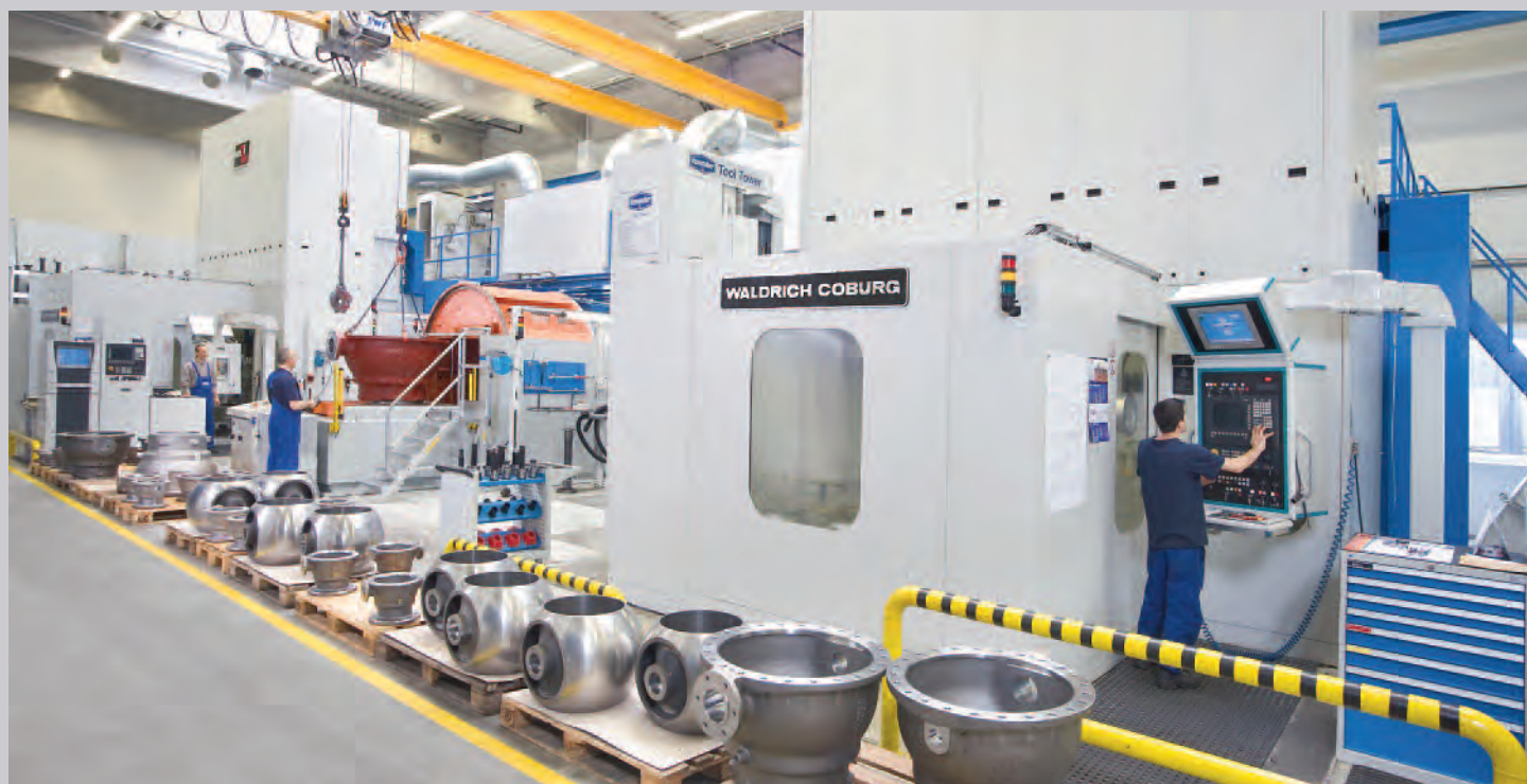
Double centre d'usinage entièrement automatisé d'un poids total de 270 tonnes
