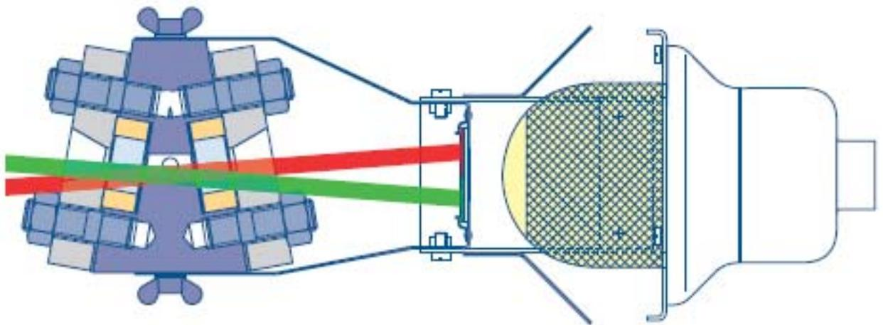
3. Pour le montage du dispositif d'éclairage sur le niveau, nous recommandons la présence de deux opérateurs: une personne pour l'ajustement de l'éclairage sur le niveau, l'autre pour vérifier la bonne visibilité des indications rouge/vert en se plaçant approximativement à 3 mètres, face au niveau.
