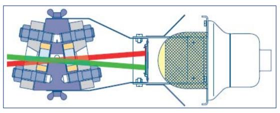
**Phase eau:** les rayons colorés sont déviés. Compte tenu de l'angle d'incidence, les rayons rouges se perdent dans le corps de niveau et les rayons verts sont reçus par l'observateur. La phase eau apparaît en vert
