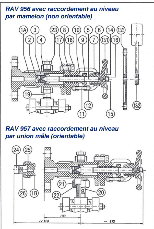
**RAV 956 avec raccordement au niveau par mamelon (non orientable)**
