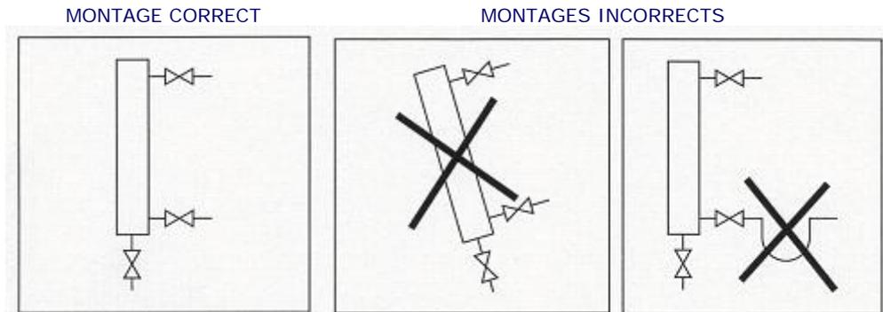
**IMPORTANT:** pour éviter au maximum la formation de condensats, les tubulures de raccordement de l'indicateur au réservoir doivent être les plus courtes possible et soigneusement calorifugées. L'appareil sera éventuellement supporté pour que la pente ramène l'eau de recondensation au réservoir. L'appareil sera calorifugé s'il est à l'extérieur.
